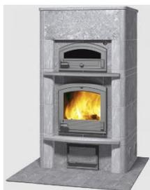
Le poêle de masse pèse entre 500 kg et 6 tonnes. Grâce à son poids (inertie thermique) il accumule la chaleur durant la flambée et la **restitue lentement jusqu'à 24h**. Une seule flambée par jour à chargement plein peut donc suffire, ce qui assure une combustion optimale à d'excellents rendements avec **un faible rejet de particules**.
