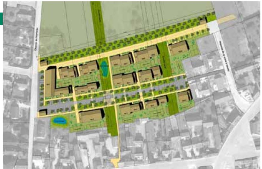
Le bâti se développe suivant un maillage est-ouest qui permet d'orienter les logements au sud afin de capter les apports solaires passifs au maximum et rechercher une efficacité énergétique.
